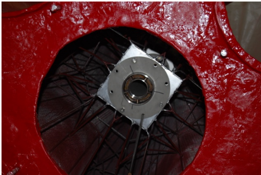
Kurz vor dem kompletten Ausschäumen mit PU-Schaum
