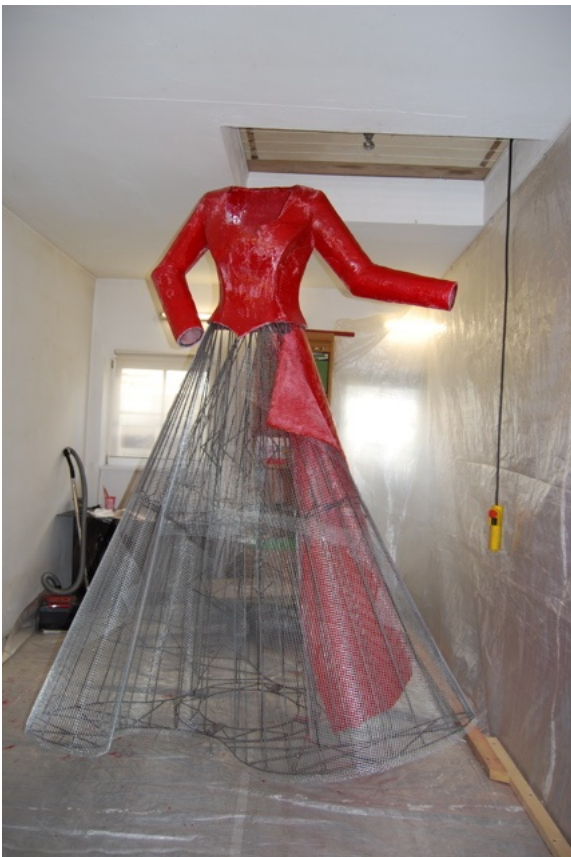
Schweißen und mit Drahtgerüst verkleiden Mit Glasfasermatten belegen. Mit eingefärbtem Epoxidharz einlassen.
