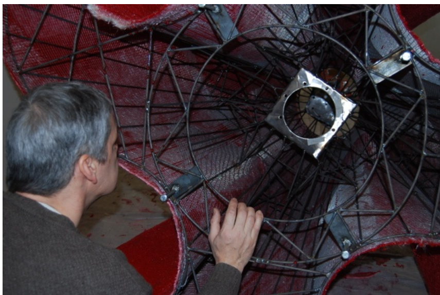
Kurz vor dem kompletten Ausschäumen mit PU-Schaum
